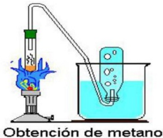
Figura 2. Montaje de laboratorio obtención de metano
